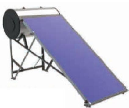
El conjunto Termosifón CSV slim, está formado por captadores solares de alto rendimiento modelo CSV SLIM 20 o 25 y un acumulador AV 150 - 500, en acero normalizado indicado para climas tropicales. Con revestimiento interior mediante esmaltado a 850°C y cámara de expansión para absorber dilataciones.
