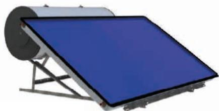
El conjunto Termosifón CSH premium, está formado por captadores solares de alto rendimiento modelo CSH PREMIUM 22 o 26 y un acumulador AV 150 - 500, en acero normalizado indicado para climas tropicales. Con revestimiento interior mediante esmaltado a 850°C y cámara de expansión para absorber dilataciones.
