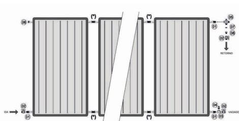
Los kits de conexión están compuestos por todos los elementos esenciales para la correcta conexión entre paneles.
