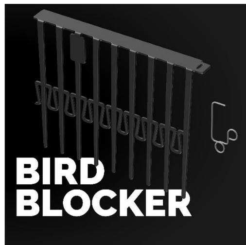
El Bird Blocker es un accesorio de polietileno de alta densidad que se coloca en el marco de los paneles. Su función principal es evitar la formación de nidos debajo de la estructura, ya que estos pueden dañar la eficiencia del sistema y generar un sobrecalentamiento.
