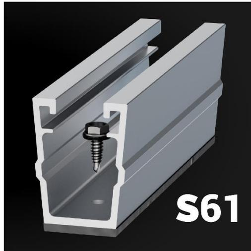
S61 es una fijación que se ancla directamente sobre la greca metálica y, ahora, al estar previamente taladrada, podrás reducir tiempo de trabajo. Funciona para todos los tamaños de módulos, incluye la tornillería necesaria y una junta de estanqueidad para sellar la unión con la chapa y prevenir filtraciones.
