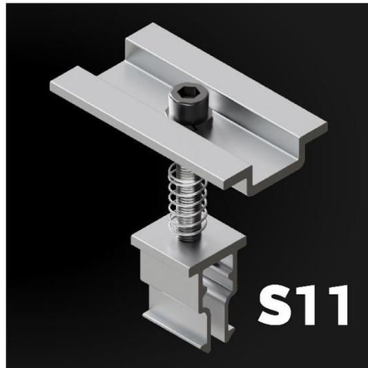
El S11 es un presor central que fija los módulos entre sí. Hemos añadido a su diseño un muelle de apoyo que hace más simple su instalación. Ya no se debe sujetar la tapa superior, simplemente alinear al perfil, bajar hasta hacer click y atornillar sin preocupación de sostener la tapa.
