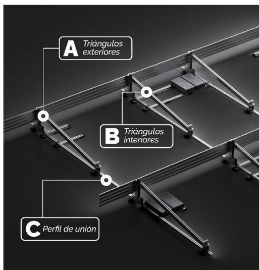
Se componen de **tres elementos**; triángulos exteriores (A), triángulos centrales (B) y el perfil de unión (C). Cada uno de los triángulos se pueden montar simplemente con un pasador y la base, gracias al **innovador sistema click**, se puede instalar simplemente con extender las partes y hacer ligera presión sobre ellas.
