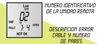
Verificación del Mapeado de un cable LAN. Obteniendo la identificación del cable y en caso de fallo el/los pares y la avería detectada.
