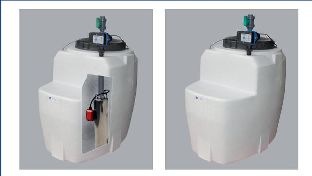
Dispone en dos versiones, una con bomba sumergible con interruptor de nivel incorporado instalada en el interior del depósito, lo cual asegura un servicio silencioso, y otra con bomba de superficie montada sobre el depósito para una mayor accesibilidad.
