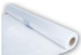
Película de polietileno de baja densidad que se coloca debajo del panel aislante, particularmente en plantas en contacto directo sobre el terreno, o que pueden absorber humedad. Su función es evitar que la eventual humedad del suelo, bien directamente, bien en forma de vapor, alcance el mortero del suelo radiante y pueda llegar a degradarlo.
