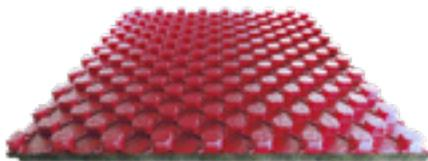
Placa aislante de tetones para instalaciones de climatización radiante según norma UNE EN 1264.4. Célula cerrada para evitar la absorción de humedad. Recubrimiento de film para evitar el apelmazamiento del aislamiento.
