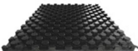
Film termoconformado de gran espesor (0,6 mm). Sistema de solapado para unión entre placas. Sistema único de fijación entre elemento base y tubo. Material EPS-ARTIC (ARTIC 384). Fabricación del film independiente del aislamiento. Los tetones de fijación protegen el tubo de los golpes durante la ejecución de la obra y mantienen una exacta separación entre los mismos.
