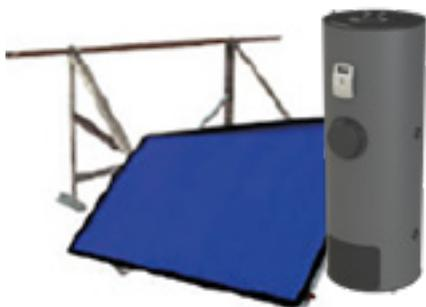
El Sistema solar drainback CSH Premium, está formado por captadores solares de alto rendimiento modelo CSH Premium 22 o 26 y un interacumulador AXD2205 150-300, construido en inox DUPLEX 2205 con soldadura a testa indicado para climas tropicales y con un serpentín de intercambio térmico para ACS totalmente extraíble y fabricado en acero INOX AISI-316L.
