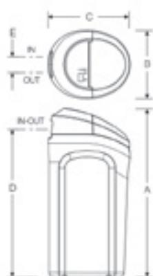
Descalcificadores de agua automáticos, de control microprocesado por demanda de agua y regeneración proporcional. Bajo consumo de sal.
