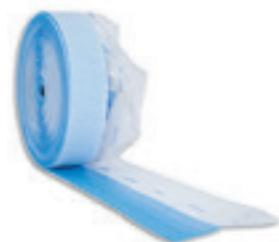
Espuma de polietileno de celda cerrada con coeficiente elástico adecuado para deformarse bajo la presión dilatométrica del mortero y permitir su expansión sin que se produzcan efectos adversos en la construcción.
