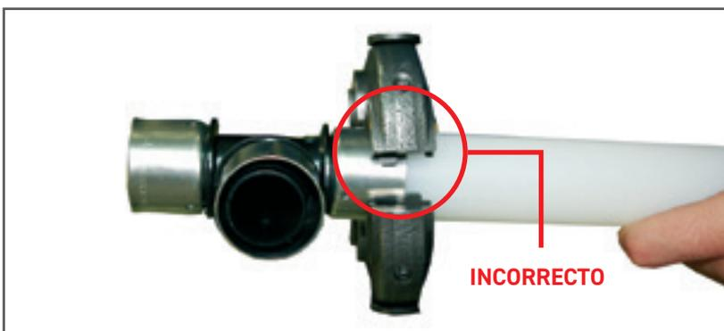
5. Insertar la inserción adecuado al diámetro exterior del tubo que se está conectando. Colocar la boca de la prensa centrada en el casquillo, pegando a la balona (No prensar nunca fuera del casquillo).
