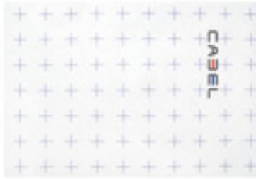
Panel aislante CABEL liso, fabricado en poliestireno expandido con grafito (EPS + grafito), autoextinguible (Euroclase E) de 25mm de espesor, densidad de 20 kg/m<sup>3</sup>, cubierto por una lámina superficial de polietileno tereftalato (PET), de 0,25mm de espesor, provisto de solapas para unión entre paneles y cuadrícula de guía serigrafiada.
