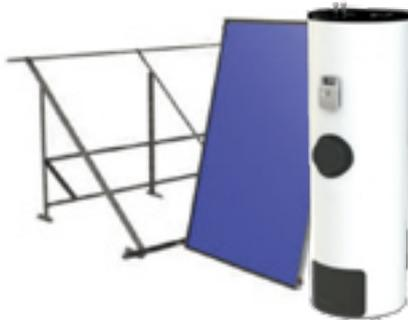
El Sistema solar drainback CSV slim, está formado por captadores solares de alto rendimiento modelo CSV SLIM 20 o 25 y un interacumulador IADSAC 150-500, construido en acero al carbono indicado para climas tropicales y con un serpentín de intercambio térmico para ACS totalmente extraíble y fabricado en acero INOX AISI-316L.
