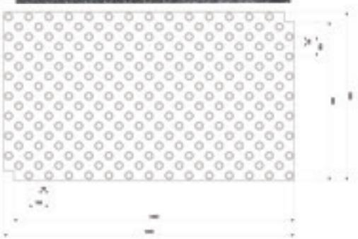
Panel aislante con tetones, en poliestireno expandido, autoextinguible (clase E), de 10, 18, 20, 25 y 40 mm de espesor útil; provisto de tetones moldeados para la fijación del tubo con separaciones en múltiplos de 50 mm, y perfiles perimetrales machihembrados para el montaje; con lámina de poliestireno termoformado, color negro, de 600 µm de espesor.
