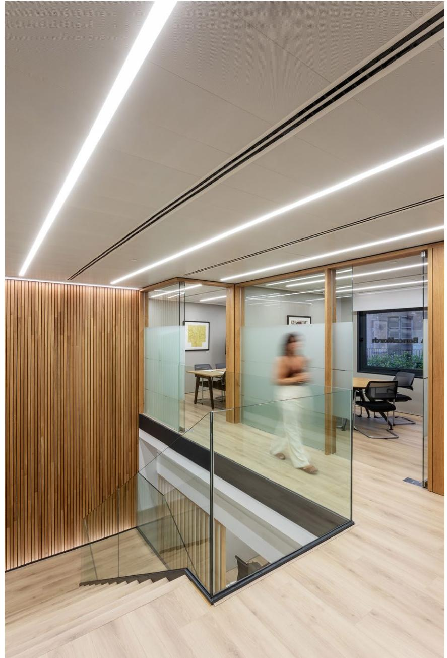
**Escaleras.** Se han utilizado tiras de LED empotradas perimetrales con ópticas asimétricas para bañar los paneles de madera noble natural. Este recurso se utiliza en varias áreas del proyecto.
