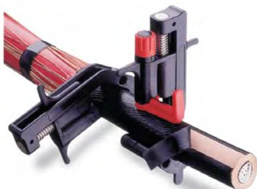
Utensilio especial para la extracción de la capa semiconductor no vulcanizada sobre el aislante de cable MT.
