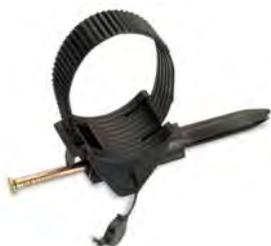
Las abrazaderas BRPF están diseñadas para la instalación de cables trenzados en fachada. Están fabricados con material termoplástico y su sistema de anclaje es mediante vástago de expansión.
