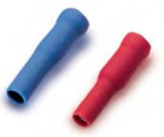
Los terminales preaislados ACH están fabricados con fleje de cobre electrolítico siendo el aislamiento en PVC. Incorporan un casquillo interior que le confiere una mayor seguridad para soportar posibles vibraciones mecánicas.
