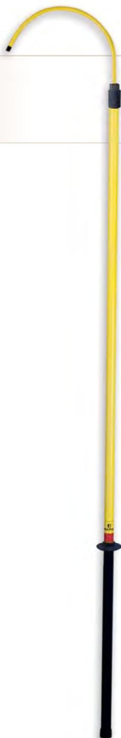
Pértigas de un solo tramo realizadas con tubo de poliéster y fibra de vidrio de Ø 32 mm. Con obturaciones antihumedad en ambos extremos, guardamanos, empuñadura, contera, cabezal métrico M-10 y gancho de salvamento.
