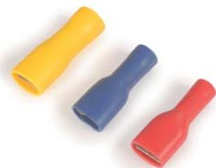
Los terminales preaislados AFH/A están fabricados con fleje de cobre electrolítico siendo el aislamiento en PVC. Incorporan un casquillo interior que le confiere una mayor seguridad para soportar posibles vibraciones mecánicas.
