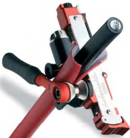
Herramienta especial Intercable para pelar la cubierta externa con espesor hasta 5mm para cable AL RH5Z1 norma ENDESA.
