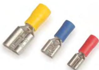
Los terminales preaislados AFH están fabricados con fleje de cobre electrolítico siendo el aislamiento en PVC. Incorporan un casquillo interior que le confiere una mayor seguridad para soportar posibles vibraciones mecánicas.
