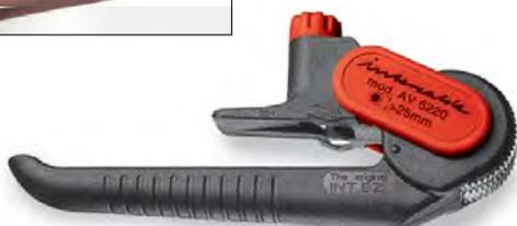
Herramienta especial Intercable para pelar la cubierta externa con espesor hasta 5mm de todos los cables MT y BT con diámetro externo min. de 25mm en lineal y circular.
