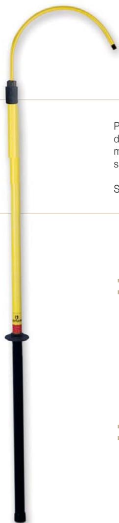
Pértigas de salvamento de un solo tramo fabricada en tubo de poliéster y fibra de vidrio de Ø 32 mm dotada de obturaciones antihumedad en ambos extremos, guardamanos, empuñadura, contera, cabezal métrico M-10 y gancho de salvamento.
