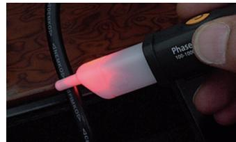
Encendido LED rojo con tensión detectada
