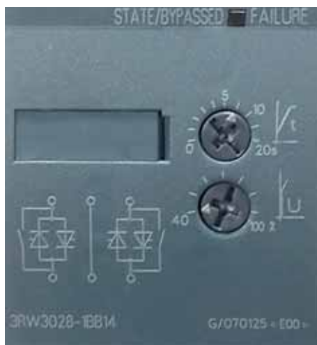
Con el SIRIUS 3RW30 del tamaño S0 (45 mm) pueden maniobrarse motores hasta 38 A.
