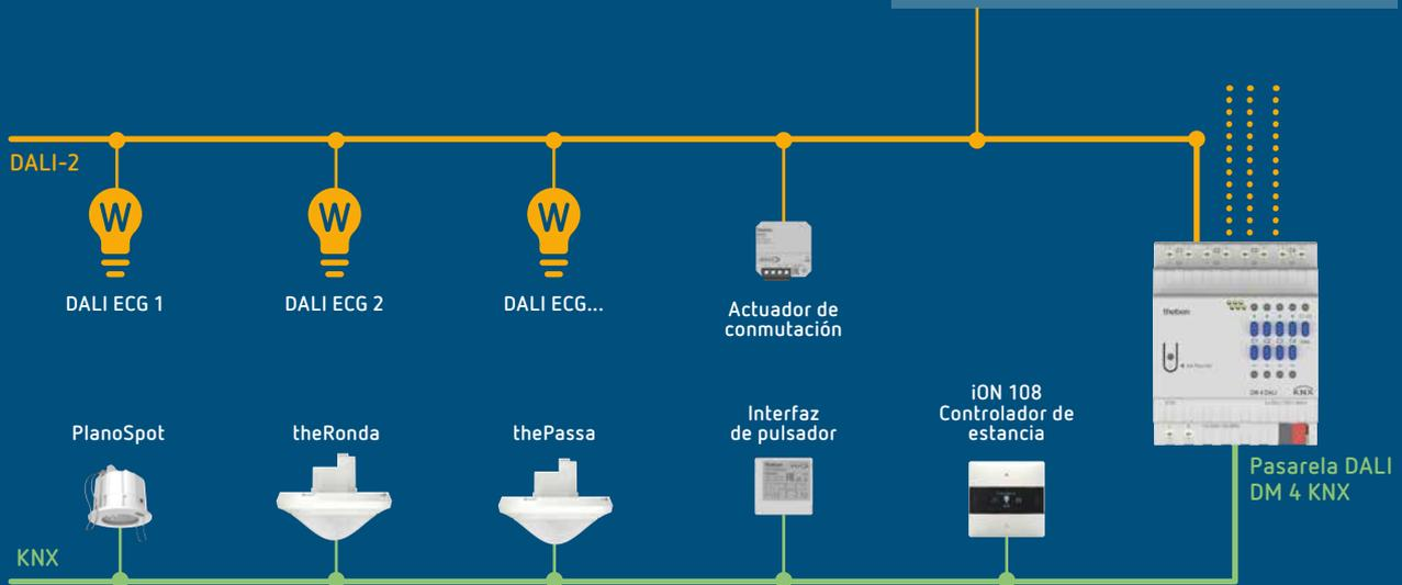
Esquema del sistema: control Broadcast
