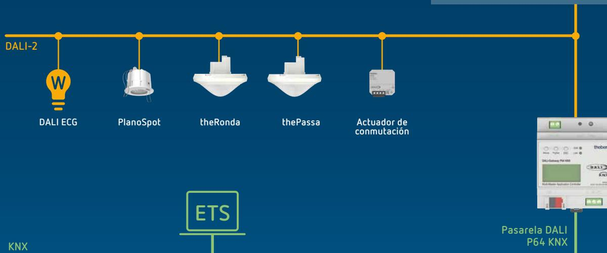
Esquema del sistema: controlador de aplicación multimaestro
