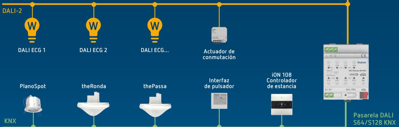
Esquema del sistema: controlador de aplicación monomaestro
